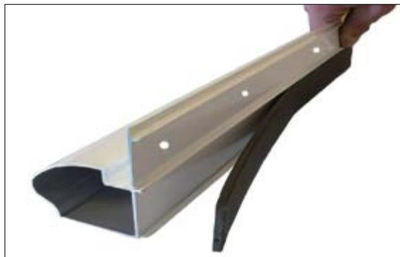
Fixer ce "Support-Mural" sur la façade à l'aide de chevilles et de vis-Alu, ou par des scellements, suivant la nature des matériaux de construction constituant la façade. Appliquer un cordon de silicone sur le dessus du profil.
